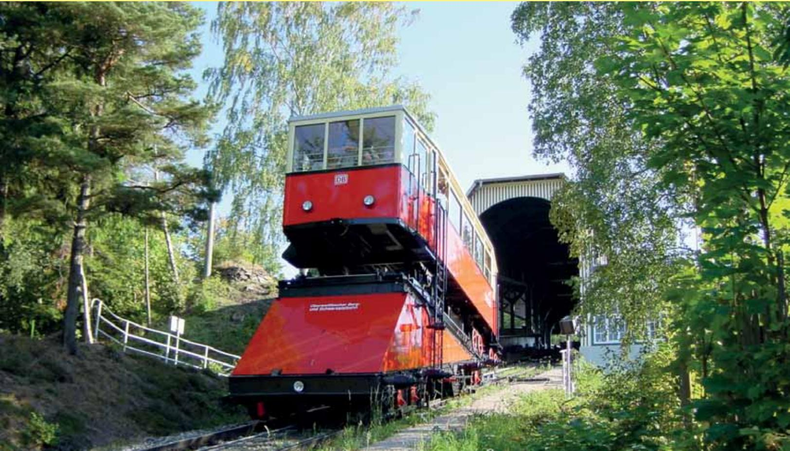
Mit 25% Steigung überwindet die weltweit einzige Standseilbahn für den Transport normalspuriger Wagen einen Höhenunterschied von 323 m - ein touristischer Magnet mit Aussichtsgarantie! Ein besonderes Highlight ist die Fahrt in unserem Cabrio-Wagen - lassen Sie sich den Wind um die Nase wehen!
